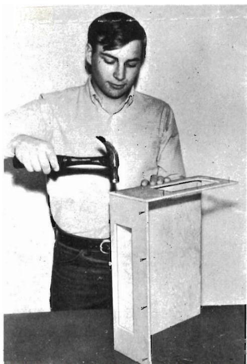
Fig. 2 - I pannelli laterali, inferiore e frontale si fissano insieme con colla e chiodi sottili. Questi ultimi devono essere fissati proprio diritti, in quanto i pannelli laterali sono sottili.
