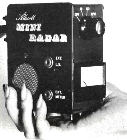
Fig. 4 - Il mini-radar Allscott si presta facilmente a molti usi e può essere usato tenendolo in mano.
